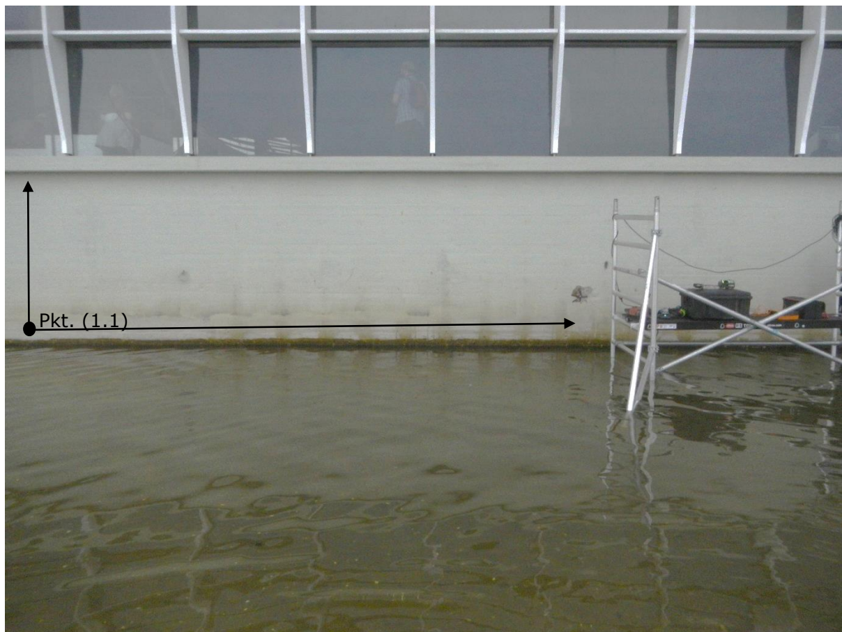
Figur 7.4.5. Placering af EKP-målefelt på facadebjælke F1. Målefeltet består af i alt 16 målepunkter i x-retningen (vandret) og 5 målepunkter i y-retningen (lodret) med målepunkt (1,1) placeret som angivet ovenfor. Målepunkterne er placeret med en indbyrdes afstand på 500 mm i begge retninger.
