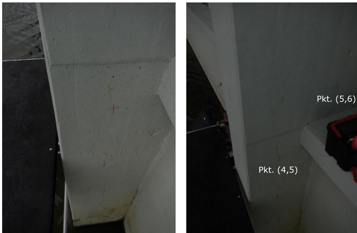
Figur 7.4.3. Placering af EKP-målefelt på søjle S2. Der er målt på alle tre sider af søjlen med i alt 5 målepunkter i x-retningen (vandret) og 8 målepunkter i y-retningen (lodret). Målepunkterne er placeret med en indbyrdes afstand på 500 mm med nederste punkt startende 60 cm over havbunden.
