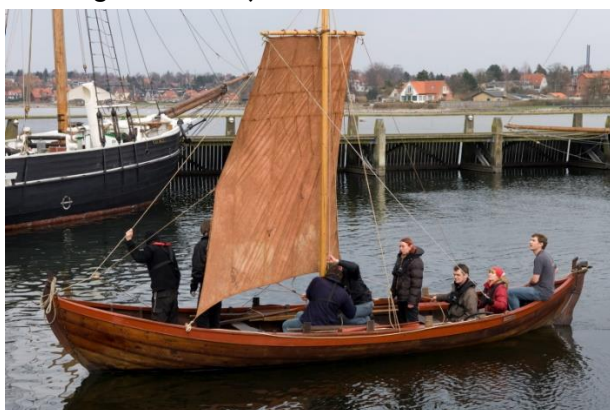
Den færøske 8-mandsbåd Trolle med sit råsejl af bomuld. I 2021 skiftes dette sejl til et uldsejl.
