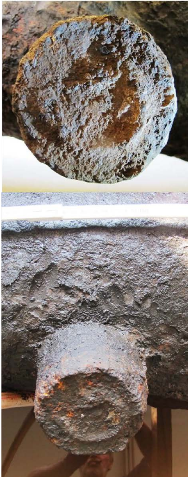
Figur 42: Detailfotos af tapmærke på kanon ID 71 (x232). Foto: Frederik Hyttel © Vikingskibsmuseet.
