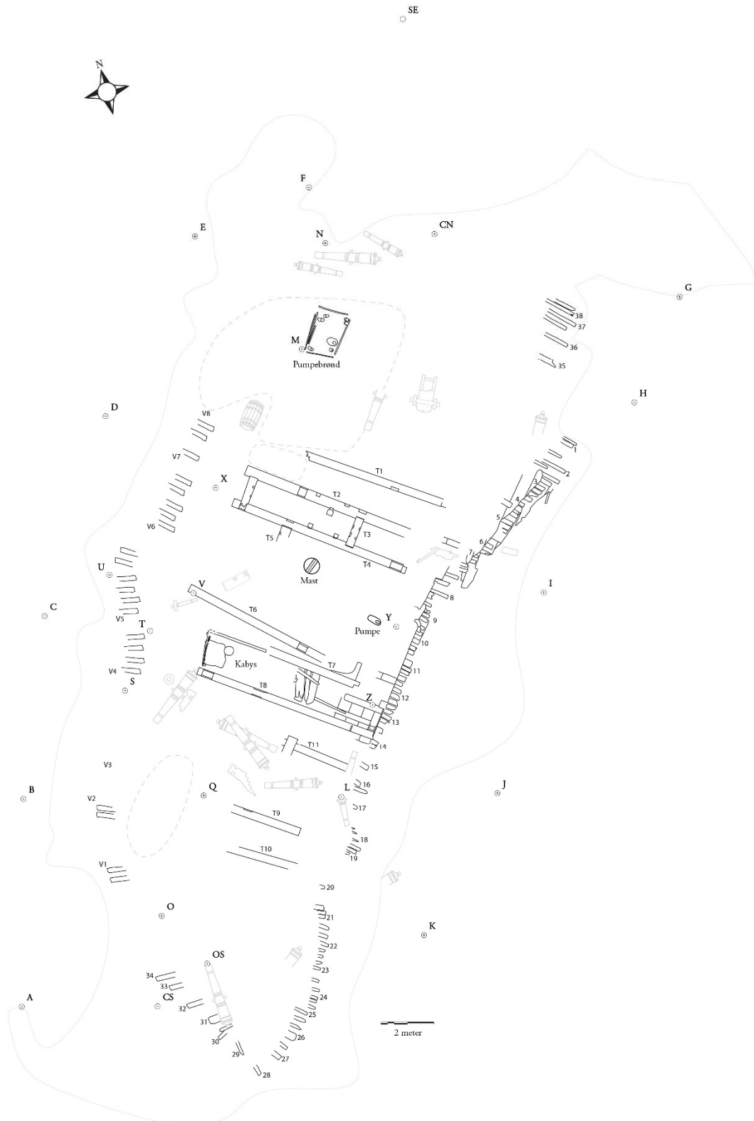
Figur 8: Plan over konstruktive elementer. Dækstømmer angivet med "T#", spanter med "#"/"V#" og målepunkter med stort bogstav. Grafik: Morten Johansen og Frederik Hyttel © Vikingskibsmuseet.
