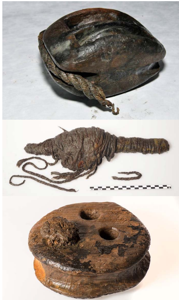
Figur 38: Øverst: Splejset øje (x46) in situ på blok (x45). Midt: Spole med tov (x203), eller line vundet op i et nøgle. Nederst: Jomfru (x248) med stopknob i et af de tre huller. Foto: Werner Karrasch © Vikingskibsmuseet.
