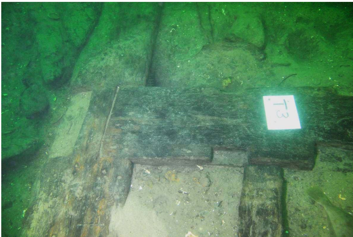
Figur 20: Kravel T3 med udskæring til ribber. En af ribberne ligger næsten på plads i kravellen. Set fra vest. Foto: Morten Johansen © Vikingskibsmuseet.
